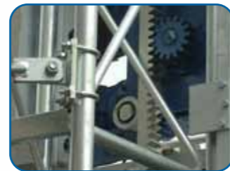
Sistema de elevación piñón-cremallera Rack-and-pinion elevating system
