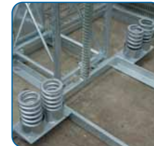
Muelles amortiguadores de seguridad Security spring buffers
